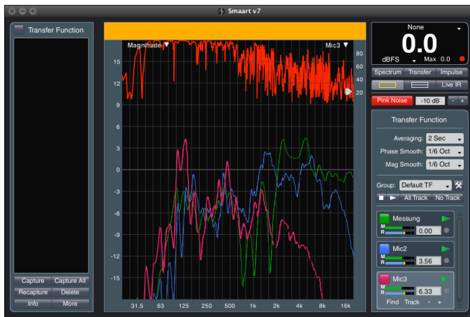
Frequenzgangmessung mit Smaart v.7
